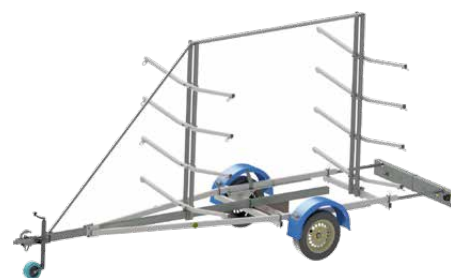
N7-17 kj: Konstrukcja do kajaków
